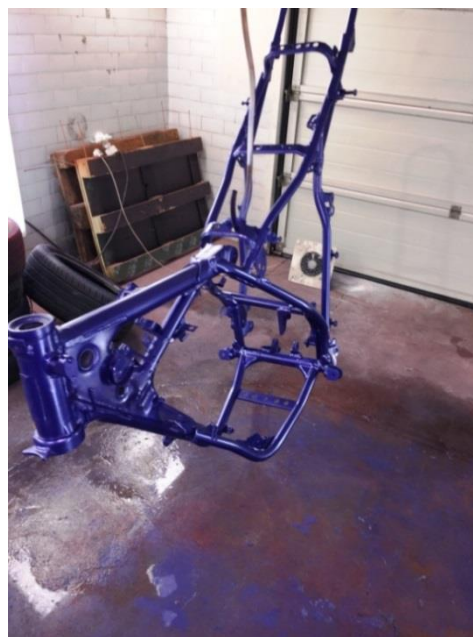
Obrázok 17 Rám po nalakovaní vrchným lakom
