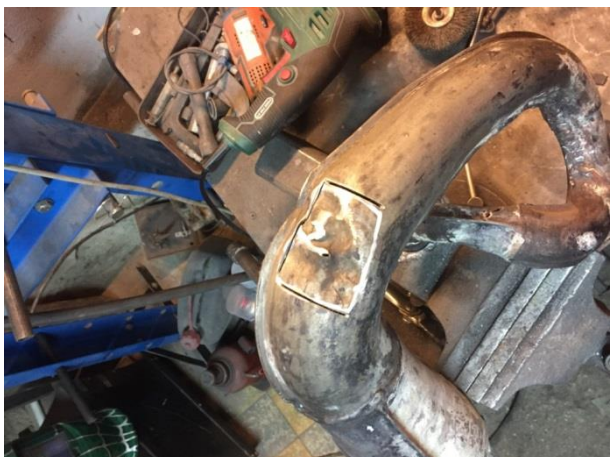
Obrázok 13 Poškodená časť výfuku
