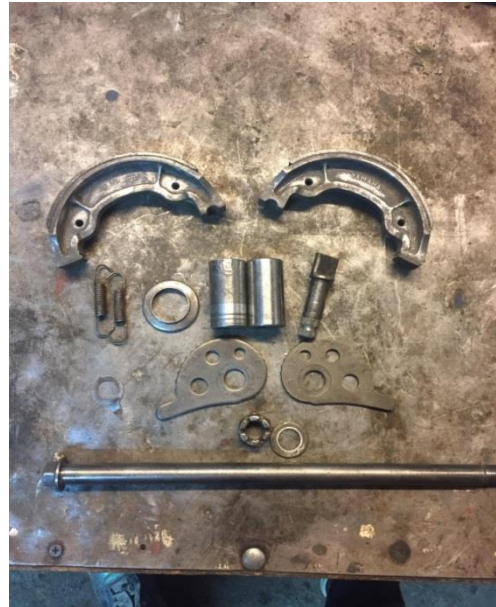
Obrázok 6 Brzdové čeluste zadnej brzdy a zavesenie zadného kola
