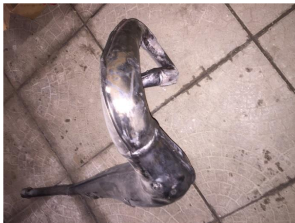
Obrázok 14 Opravené výfukové potrubie
