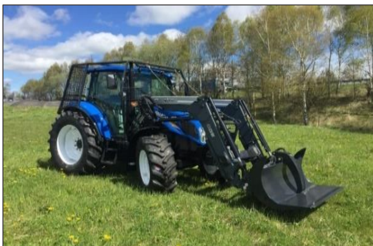
Obr. 28 Traktor s ochrannou mrežou a uchopnou radlicou na drevo
