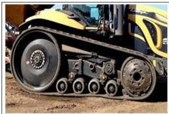
Obr. 17 Pásové traktory s tuhými podvozkami
