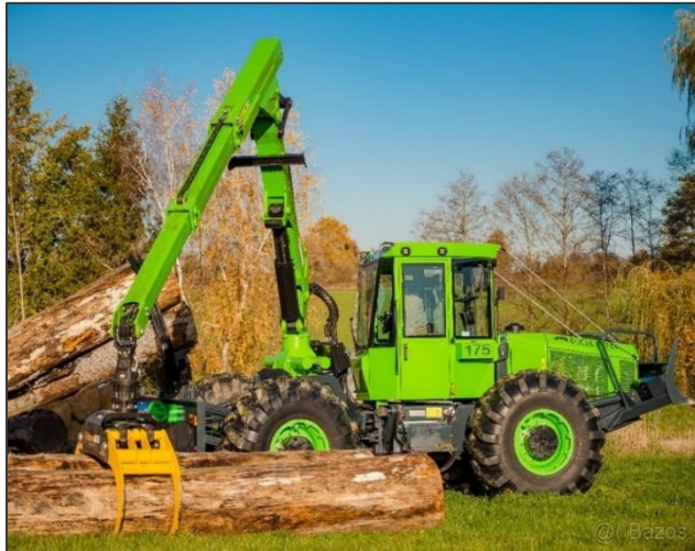
Obr. 33,34 Lesný traktor EQUUS 175N BH a vybavenie kabíny
