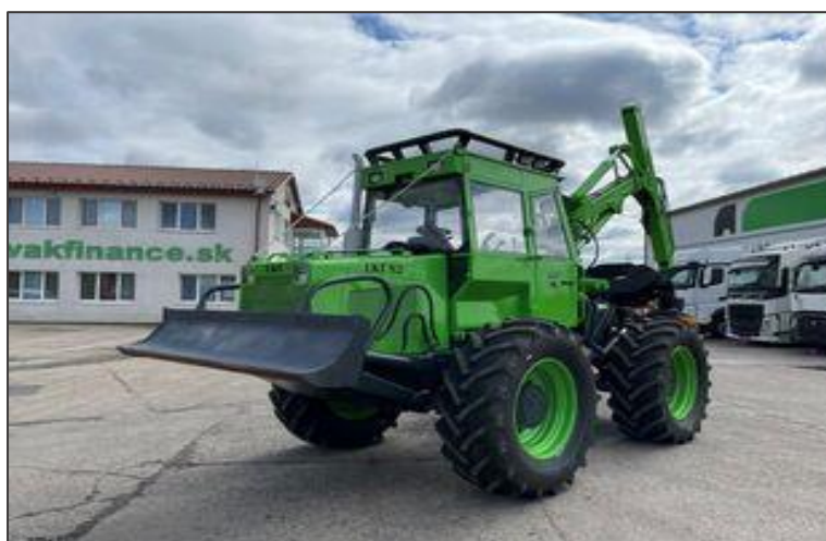
Obr. 35 Lesný traktor Zetor LKT 82C 4x4 s radlicou
