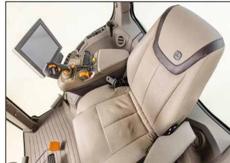
Obr. 12 Vybavenie kabíny traktora- odpružené sedadlo pre komfort jazdy
