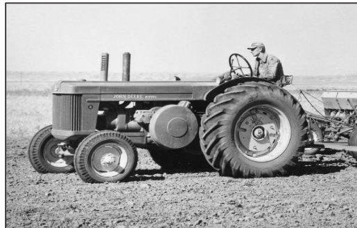
Obr. 6 Model R John Deere s dieslovým motorom, ktorý je poháňaný malým benzínovým motorom spúšťaný elektromotorom - rok 1949
