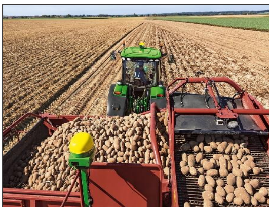
Obr. 29,30 Synchronizácia strojov John Deere Machine Sync
