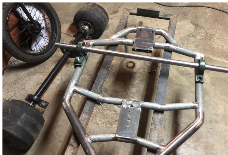
Obr. 13 Rám trojkolky s oskou v ložiskových domčekoch
