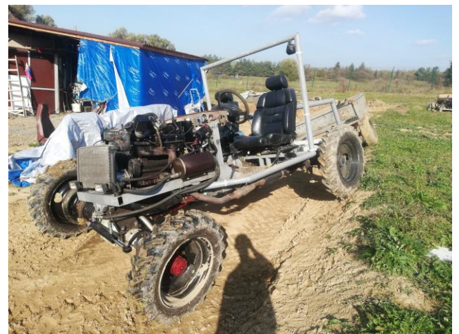
Obr.19 Montáž sedačiek, riadenia a skúška kríženia nápravy
