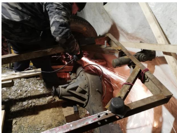
Obr. 18 Stavba hlavného rámu a uloženie motora, prevodovky a nápravy
