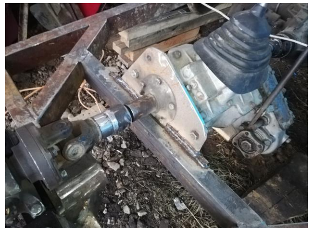
Obr. 18 Stavba hlavného rámu a uloženie motora, prevodovky a nápravy
