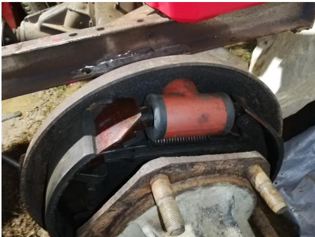
Obr. 13 Montáž jedného zo štyroch nových valčekov
