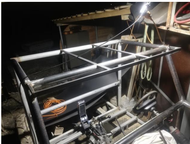
Obr.19 Výroba ochranného rámu a montáž ramien
