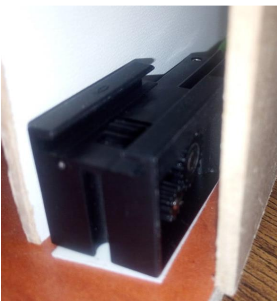
Obr. 16 Ozubená predovka s motorom
