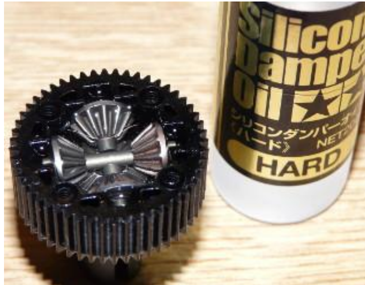
Obrázok 9: Planetový diferenciál s ocelovým ozubením
