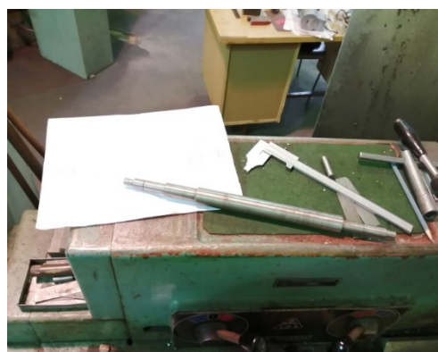
Obr. 13 Dokončovanie hriadeľa [foto: Hrušovský, P., 2020]
