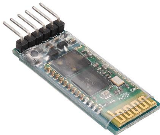
Obr. 8 HC-05 Bluetooth modul
