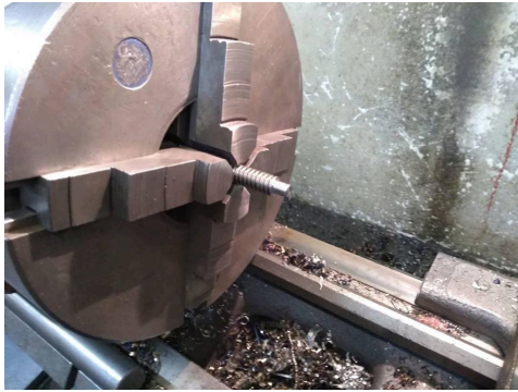
Obr.8 Opracovanie zadného konca skrutkovice (os X)
