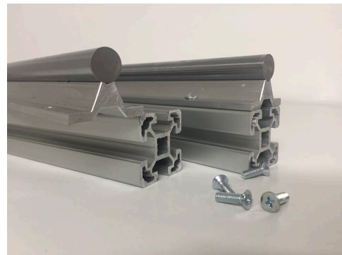
Obr.2 Montovanie podopretých tyčí
