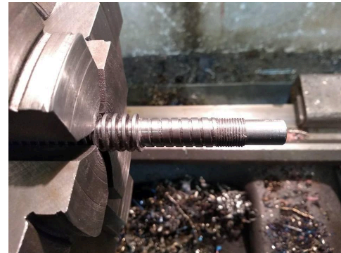
Obr.10 Rezanie závitů pre poistnú maticu (predná časť)
