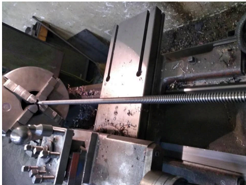
Obr.9 Sústruženie prednej časti (os X)
