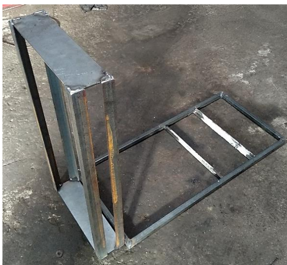
Obr. 3 Zváraná konštrukcia [foto Baláži, M., 2018]
