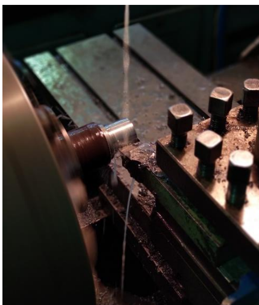
Obr. 6 Sústruženie uloženia na reťazové koleso [foto Baláži, M., 2018]
