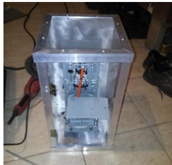
Obr. 17 Dokončený kryt CNC stroja [Jozef Nemčík - 20.1.2018]
