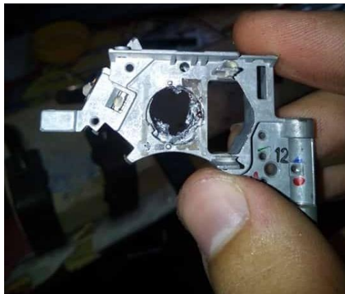
Obr. 6 Jazdec s navŕtanou dierou a narezaným závitom [Jozef Nemčik – 10.8.2017]
