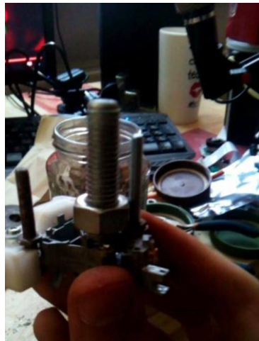
Príloha C - Obr. 5 Hliníkový jazdec s osadenými skrutkami [Jozef Nemčík – 29.7.2017]
