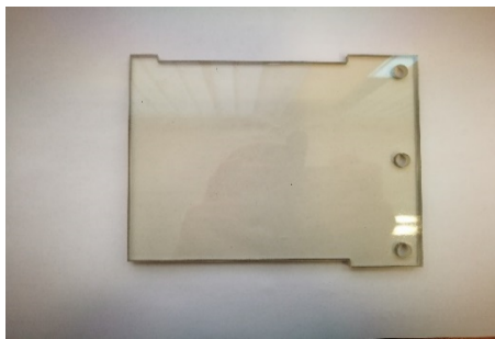
Obr. 22 Modely pôvodného a odľahčeného nosníka vyrobené z opticky citlivého materiálu
