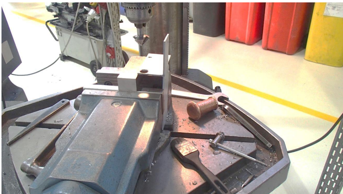
Obr. 7 Vrtanie dier pre upevnenie káblov (foto Gmuca, A., 2017)
