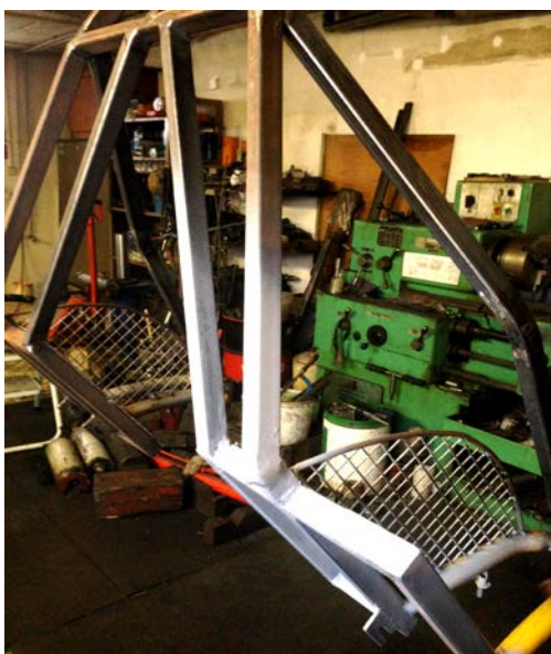
Obr. 12 Nanášanie základnou farbou (foto Štiavnická, A., 2018)
