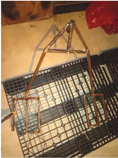
Obr. 9 Pripevnenie stupaji ku zvyšku konštrukcii (foto Štiavnická, A., 2018)
