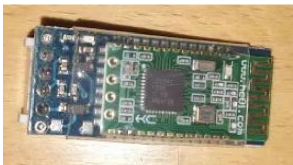
Obr. 6: Použitý Bluetooth modul
