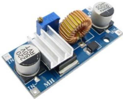
Obr. 8: Použitý stabilizačný zdroj
