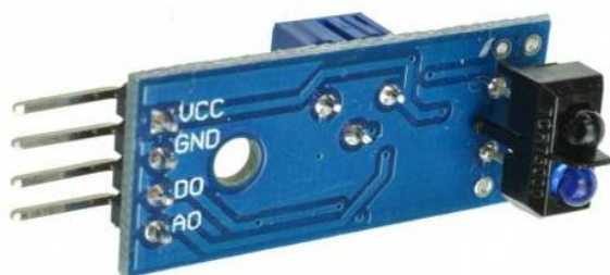
Obr. 5: Použitý infračervený optický senzor
