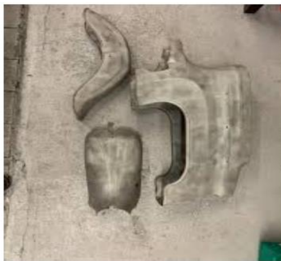
Obrázok 3: Pieskovanie a brúsenie všetkých kovových častí.
