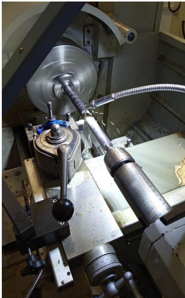
Obr. 10 Sústruženie aretačných kolíkov (Autor: Martin Kožuško, 11.12.2025)
