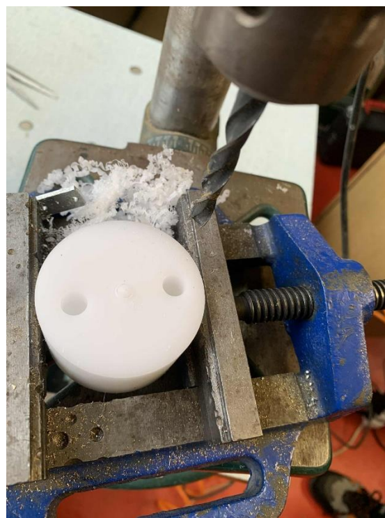
Obr. 13 Vytváranie otvorov pre kolíky
