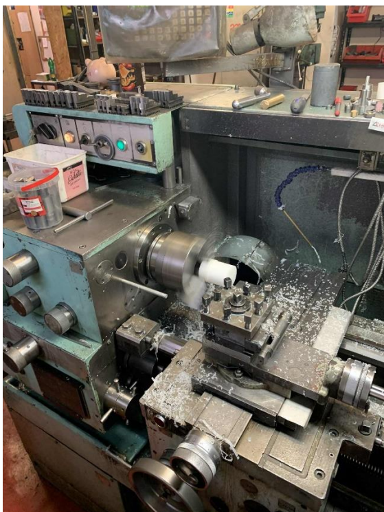
Obr. 12 Sústruženie na požadovaný priemer
