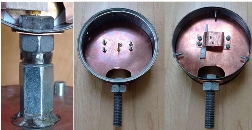
Obrázok 3 Upnutie manometra pomocou skrutky
