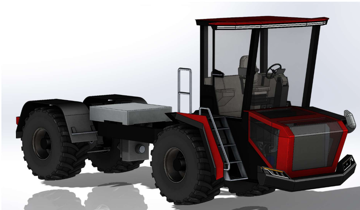
Hotový nosič modulov (vývojový náter)
