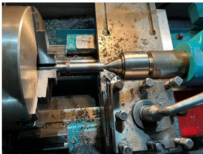
Obr. 2 Sústruženie hriadela [Zdroj: Mrovčák, 2025]
