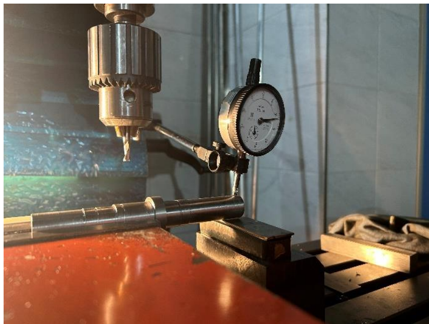
Obr. 4 Kontrola kvality hriadeľa [Zdroj: Dutko, 2025]
