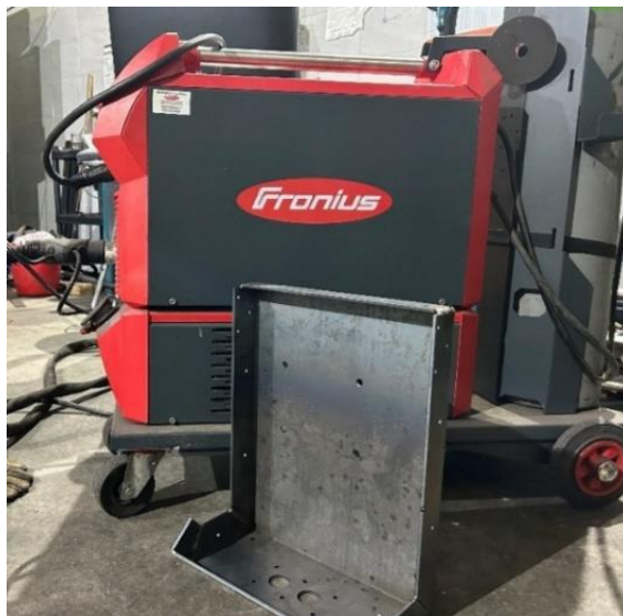
Obr. 7 Zváraná konštrukcia [Zdroj: Dutko, 2025]
