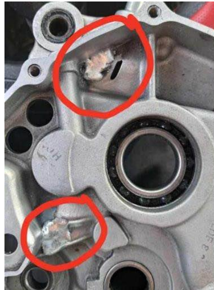
Obrázok 3 Karter po opravě
