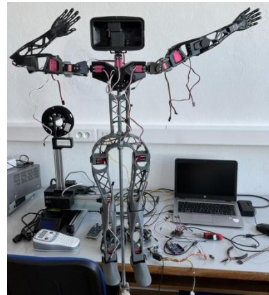
Obr. č. 9 - Osadené servomotry
