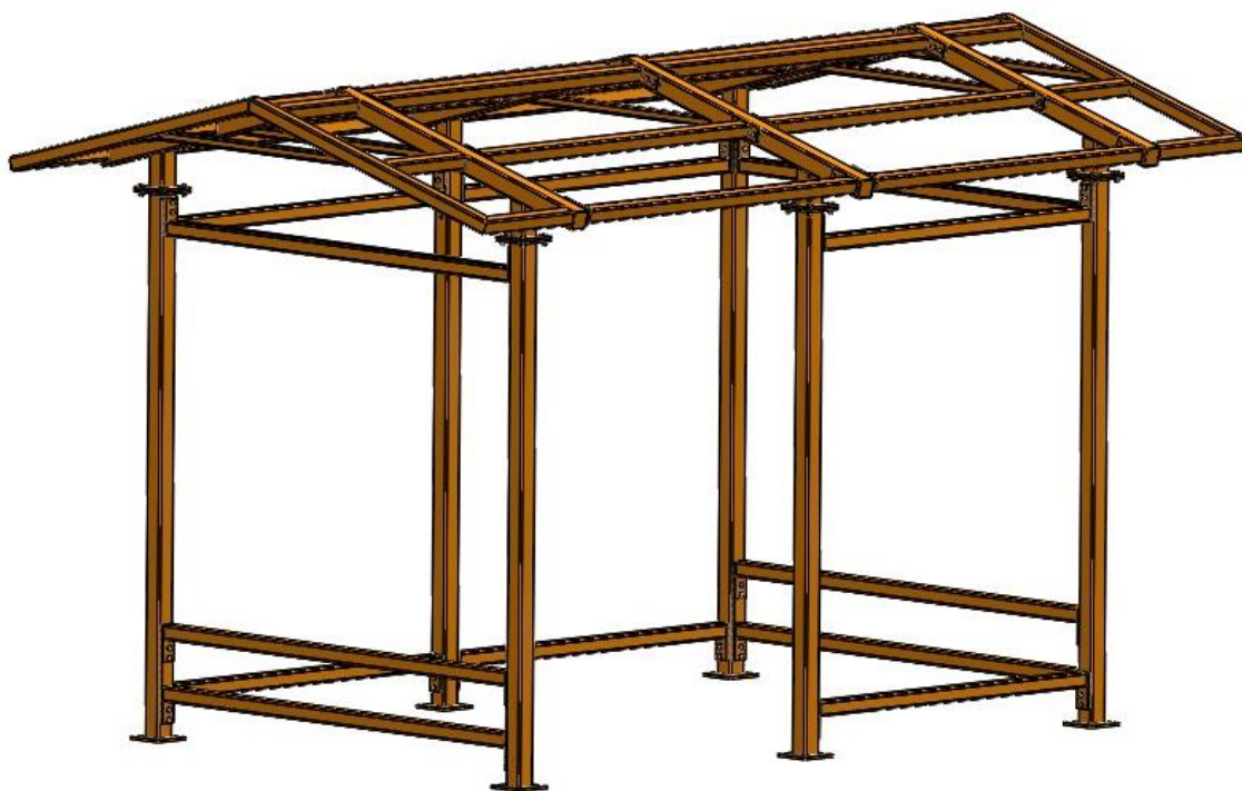
Obr. 21 Návrh konštrukcie zastávky v SOLIDWORKS
