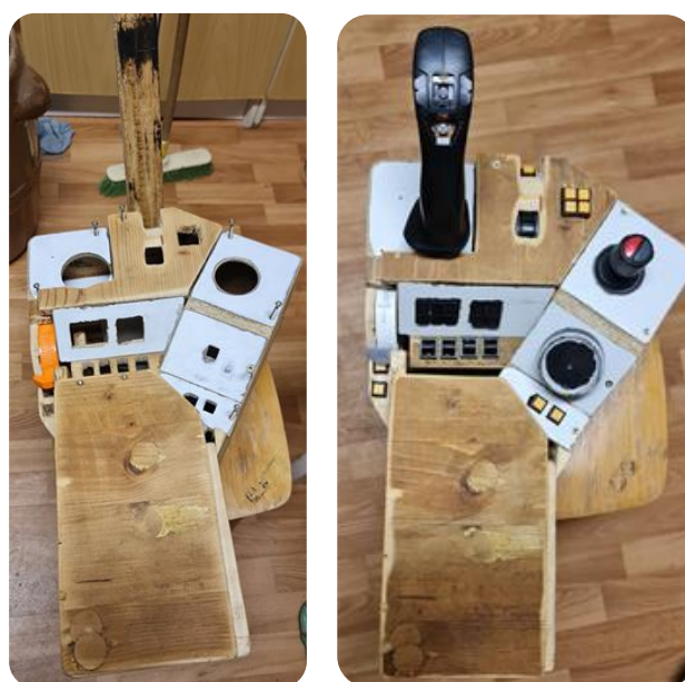
Obr. 4 Vyrezávanie otvorov do vrchného panelu
