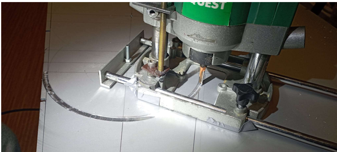
Príloha 2: Frézovanie hliníkového plechu na bok prevodovky
