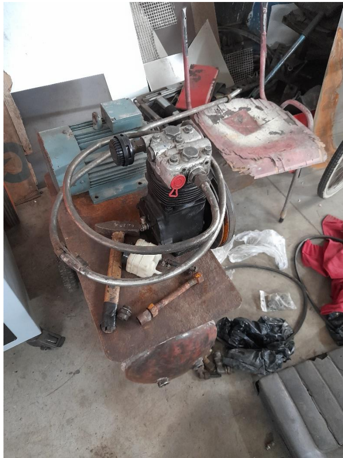
Zapájanie kompresora (Zdroj, Kopko, L., 2023 )
