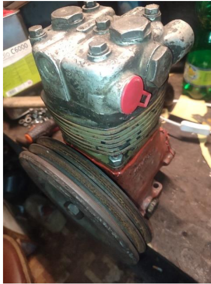
Obrázok 4 Kompresor po repase (Zdroj, Kopko, L., 2023)
