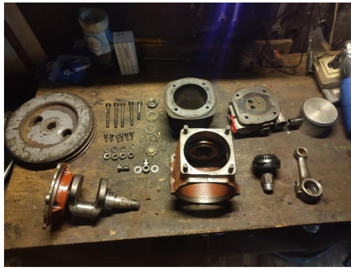
Obrázok 3 Rozobratie kompresora (Zdroj, Kopko, L., 2023)
