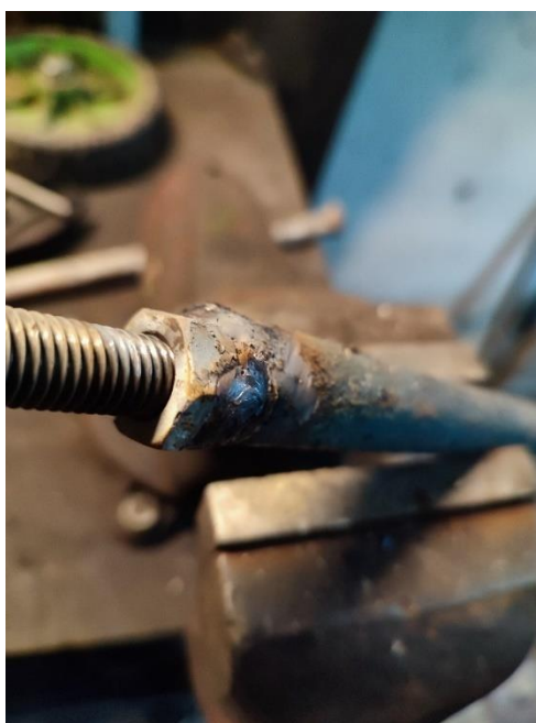
Zváranie matíc ku rúrke (Zdroj, Kopko, L., 2023 )
