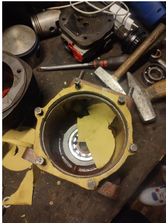
Tesnenie ku prírubе (Zdroj, Kopko, L., 2023)
