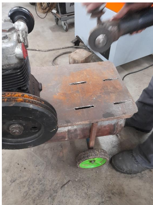
Rezanie drážok na upevnenie elektromotora (Zdroj, Kopko, L., 2023 )
