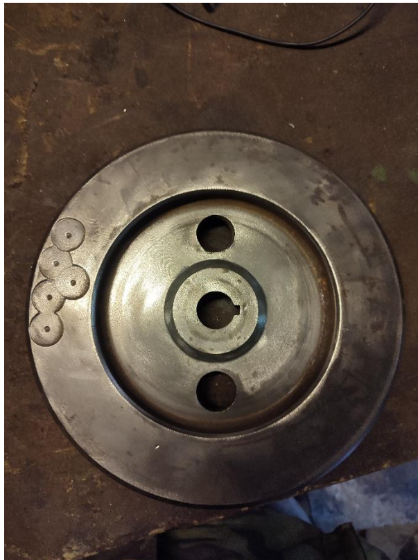
Vybrúsená remenica (Zdroj, Kopko, L., 2023)
