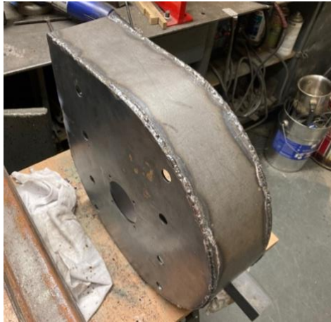
Obr. 4 Zvarený plášť s bokmi skrine [foto: Bies D., 2023]
