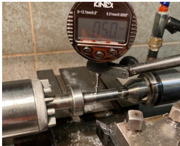
Obr. 10 Výroba kužeľa na hriadeľi pomocou odchýlkomera [foto: Bies D., 2023]
