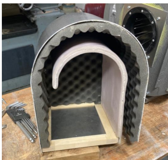
Obr. 7 Tlmič z vnútra (labyrint, klapka) [foto: Bies D., 2023]
