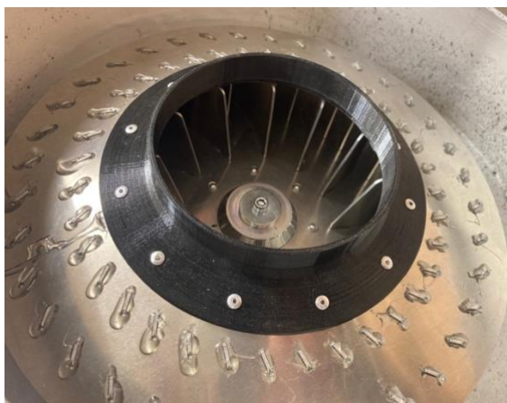
Obr. 14 Obežné koleso s nasávacím hrdlom [foto: Bies D., 2023]
