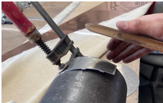
Obr. 12 Ohýbanie lopatiek na forme [foto: Bies D., 2023]
