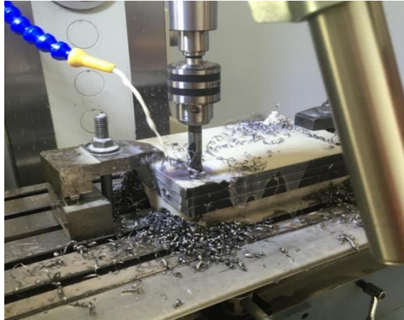
Obrázok 3. Vŕtanie vodiacích dier (foto: Jalč, L., 2022)
