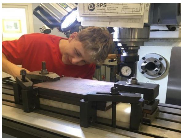
Obrázok 2. Centrovanie platní (foto: Jalč, L., 2022)
